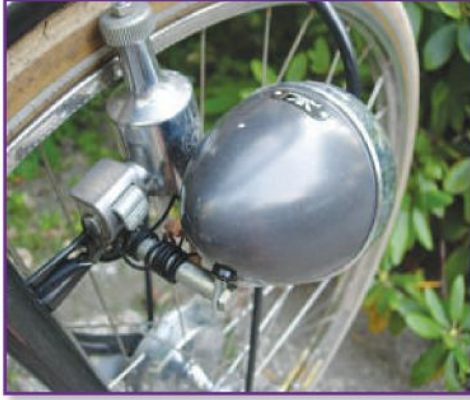
يتصل المولد الكهربائي بعجلة الدراجة
