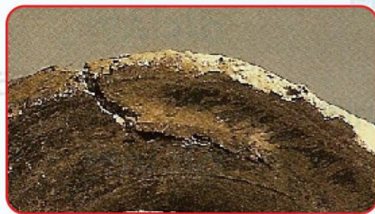
شكل (١٠٦): يوضح نتائج أخطاء التجفيف ( تشقق ).
