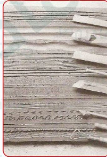
شكل (١١٨): أثر أدوات تشكيل الخشب (الدفنر) على سطح الطين المتجلد.
